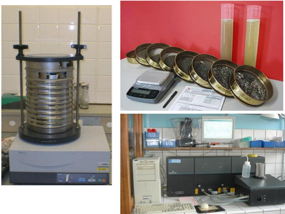
Figure 5 : Série de tamis de la norme AFNOR avec tamiseuse et granulométrie de Laser
